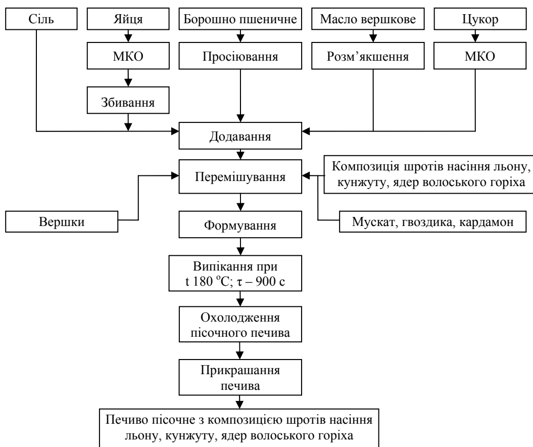
Рис. 1. Технологічна схема приготування пісочного печива із композицією шротів
